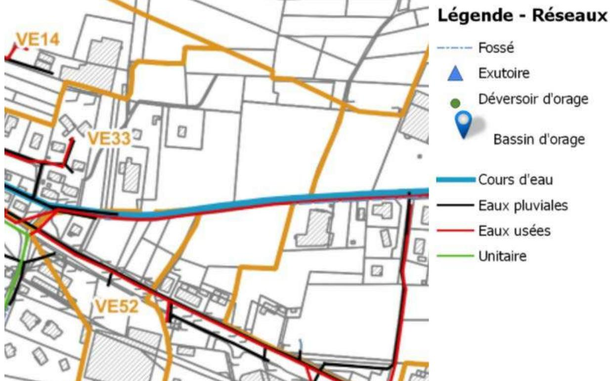
**Figure 66 : Localisation des réseaux (assainissement et pluvial) disponibles sur et aux abords du site.**
